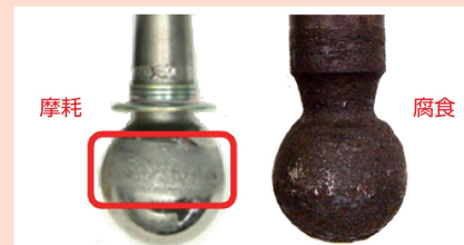
ステアリング・タイロッド・エンド内部の継手部(本来は非分解)
