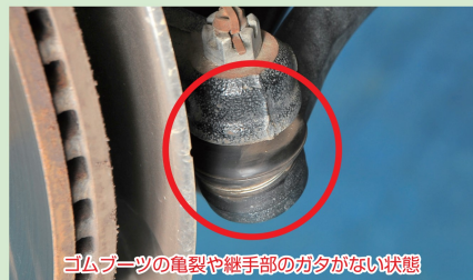
ゴムブーツの亀裂や継手部のガタがない状態
