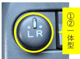
図のように「L(左)/R(右)」と「上下左右」の調整部分が一体型の場合、①スイッチのつまみを左右にまわしてミラーを選択し、②丸いスイッチを傾けて上下左右の位置を調整します。
