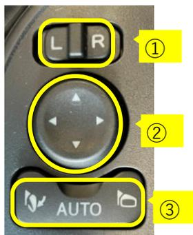
図のように①「L(左)/R(右)」の部分で調整するミラーを選択し、②上下左右のボタン「△の方向」で調整します。
