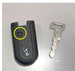
○印の部分をスライドさせて鍵を引き抜いてから電池交換をしてください。
