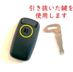
○印の部分をスライドさせて鍵を引き抜いてから電池交換をしてください。
