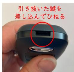
引き抜いた鍵を○印へ差し込んでひねるとカバーが外れます。
