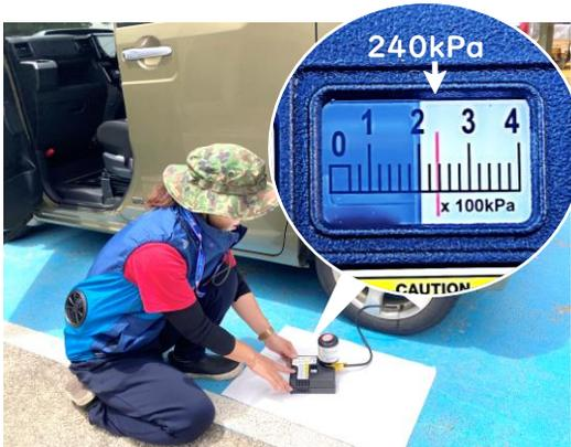
⑫ 空気圧ゲージで確認しながら指定空気圧になるまで上昇させる。
