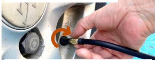
⑤ ホースの口金からホース栓を取り外しパンクしたタイヤのバルブに接続する。(いずれもネジ式)
