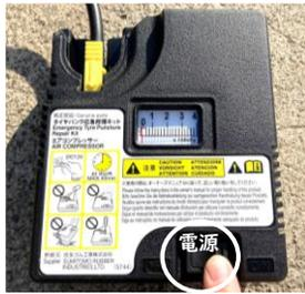
⑦ コンプレッサーの電源プラグを車両のシガライタースOCKETに差し込む。
