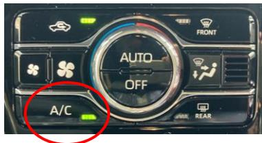
エアコンは1年を通して常にONにしておくことをオススメします。これにより、車内の湿気を効果的に除去してエバポレーターに付着する水滴の汚れを減らしカビの発生を防ぐことができます。また、エアコン本体の故障やガス漏れを予防する効果も期待できるため、常に作動させるようにしましょう！
