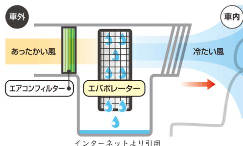
臭いの原因は、エアコン内部にある冷たい風を作るエバポレーターやエアコンフィルターに発生したカビが原因です！エバポレーターは、車のエアコンを稼働している時には冷たい状態のため、冷たい飲み物に水滴がつくように濡れています。さらに他から入ってきた汚れた空気やホコリ、ゴミの影響もあって、カビが繁殖しやすい環境が整っているのです。
